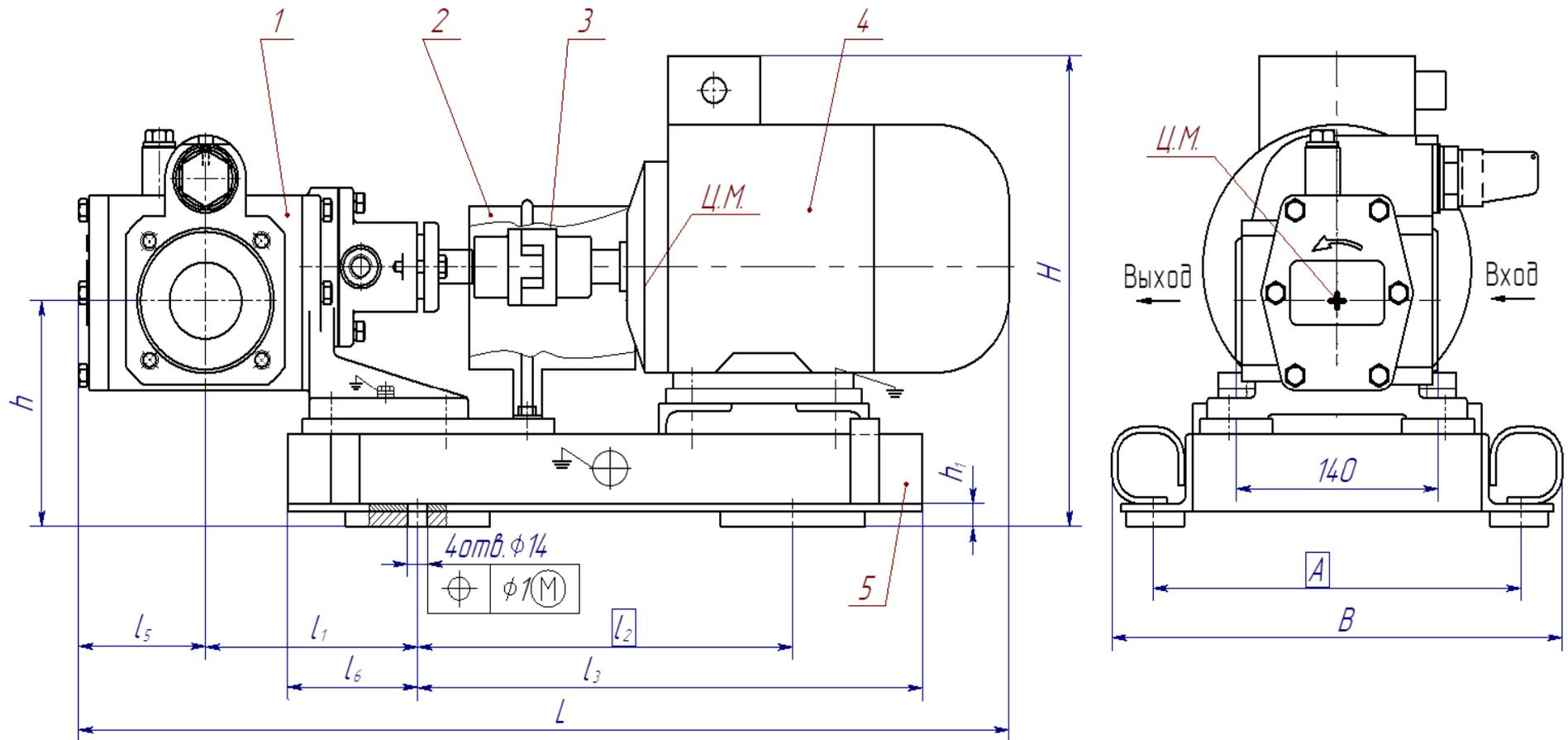
Рисунок Б.7 Габаритный чертеж электронасосных агрегатов на основе насосов с уплотнениями ТТ, ТД, С вне зависимости от материального исполнения корпусных деталей, РТИ и втулок.
