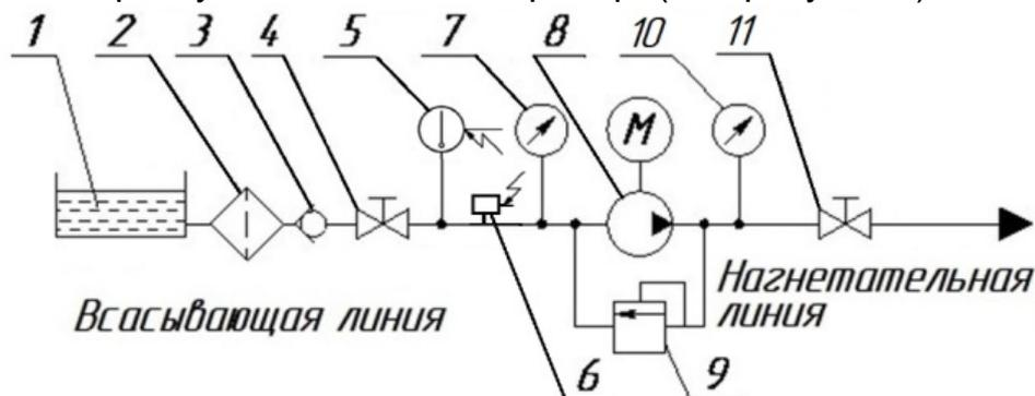
Рисунок 2 – Схема включения агрегата в сеть
